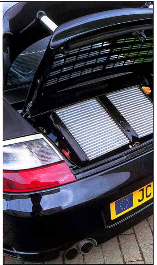
1.巨大なインタークーラーによってエンジン本体を覗き見ることはできないが、GT1の流れを汲むGT3用3.6ℓユニットをベースとしたターボチューンドとなっているのである。2.300km/hスケールのメーターはもはや完全に役不足。3.フロントは10Jホイール245/40ZR18。リヤは315/30ZR18というタイヤをチョイス。このファットなタイヤです620psの前ではラフなアクセル操作を容認してはくれない。4.リヤバンパーはターボをモディファイ、さらにオリジナルウイングを装着している。
